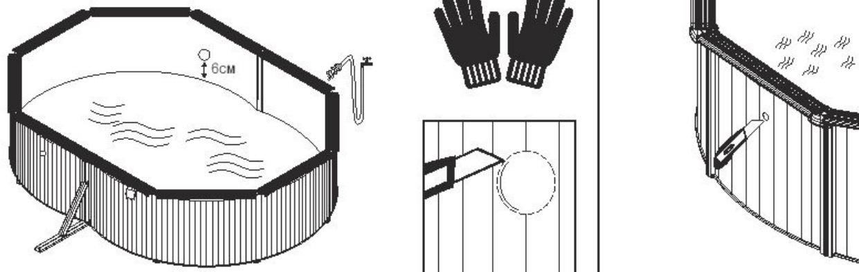
**ПРИМЕЧАНИЕ:** Перед тем, как присоединить клапан к бассейну, наполните бассейн водой, не доходя 5-6 сантиметров до места расположения соединительного клапана.
