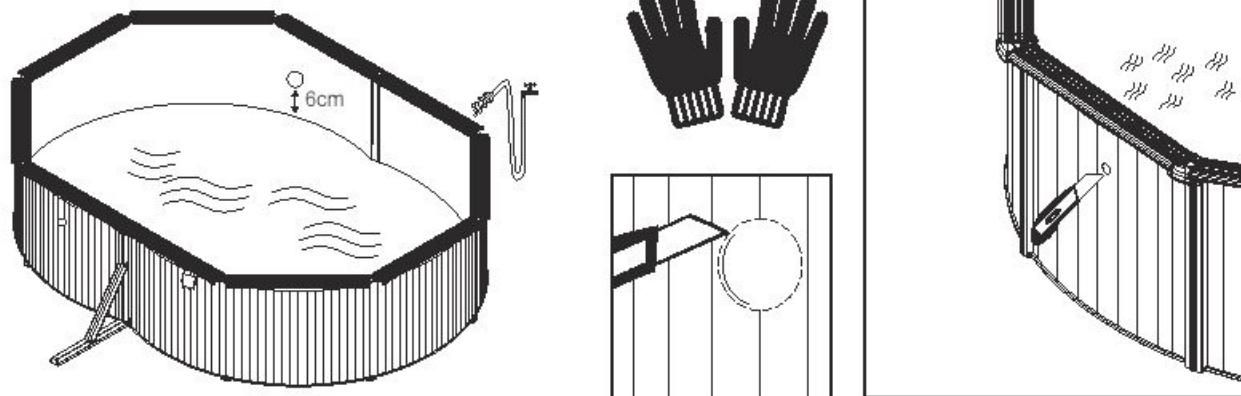
**UWAGA:** Przed podłączeniem zaworu do basenu napełnij basen pozostawiając odstęp 5 – 6 cm między położeniem zaworu łączącego a powierzchnią wody.
