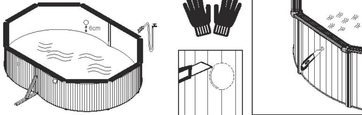
**NOTA:** Antes de ligar a válvula à piscina, encha a piscina deixando 5 - 6cm de espaço entre a posição da válvula de ligação e a superfície da água.
