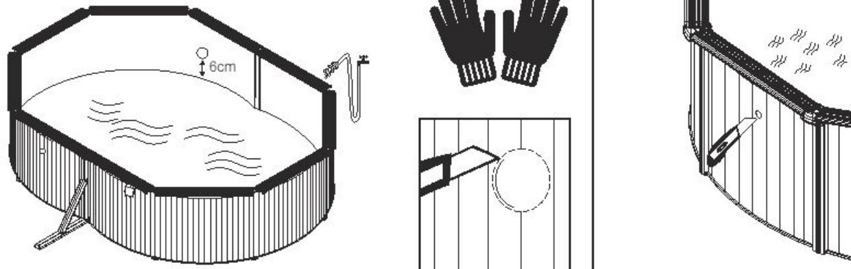
**HINWEIS:** Füllen Sie den Pool bis zu einer Höhe von 5 - 6cm zwischen der Position des Anschlussventils und der (späteren) Wasseroberfläche mit Wasser, bevor Sie das Ventil am Pool befestigen.
