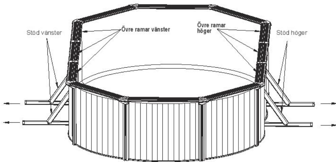
Försäkra dig om att de övre ramdelarna är i linje med varandra genom att röra på stöden.
