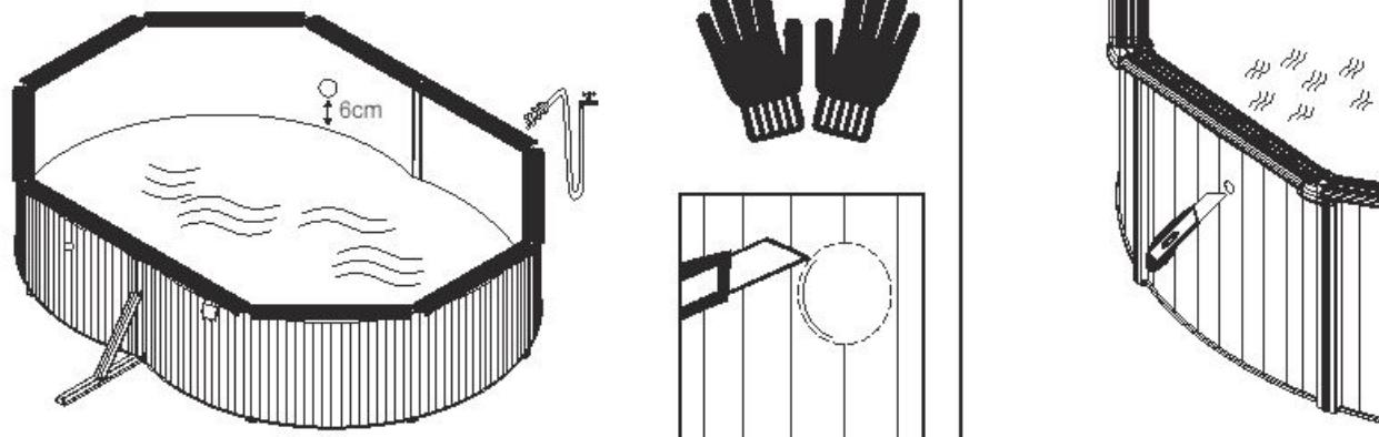
**MEGJEGYZÉS:** A szélepek a medencéhez csatlakoztatása előtt töltse fel a medencét vizsel úgy, hogy a vízsint 5 vagy 6 cm-rel a csatlakozószelep helyzete alatt legyen.
