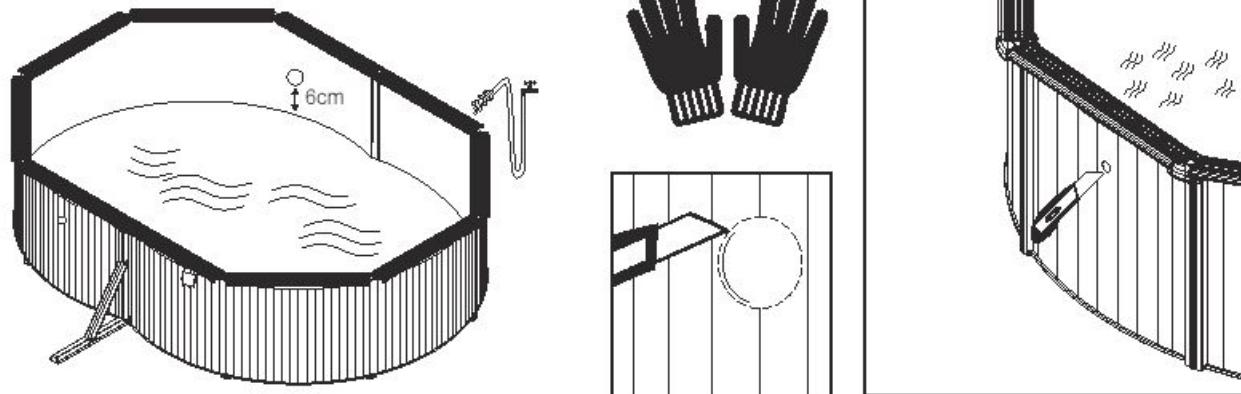
**OPMERKING:** Vooraleer de klep te verbinden met het zwembad, vul het zwembad en laat daarbij 5 - 6 cm ruimte tussen de positie van de aansluitingsklep en het wateroppervlak.
